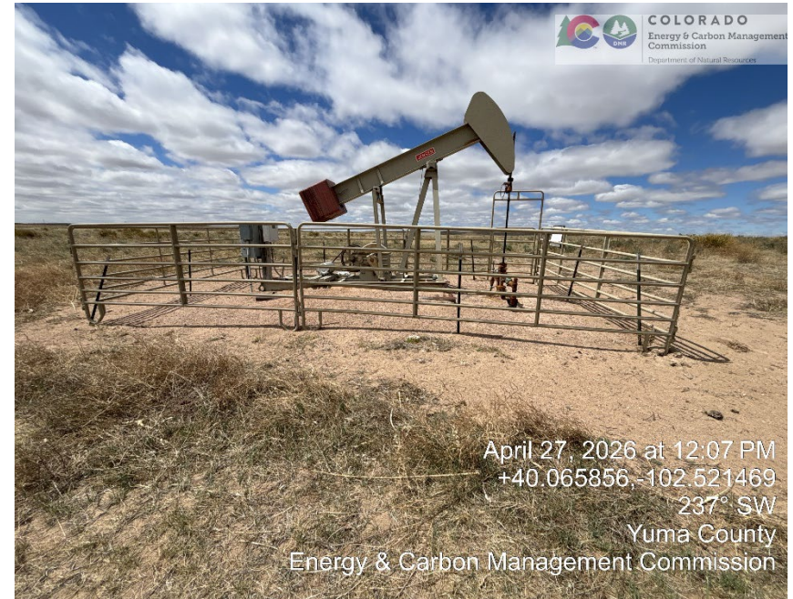
PU and Wellhead
