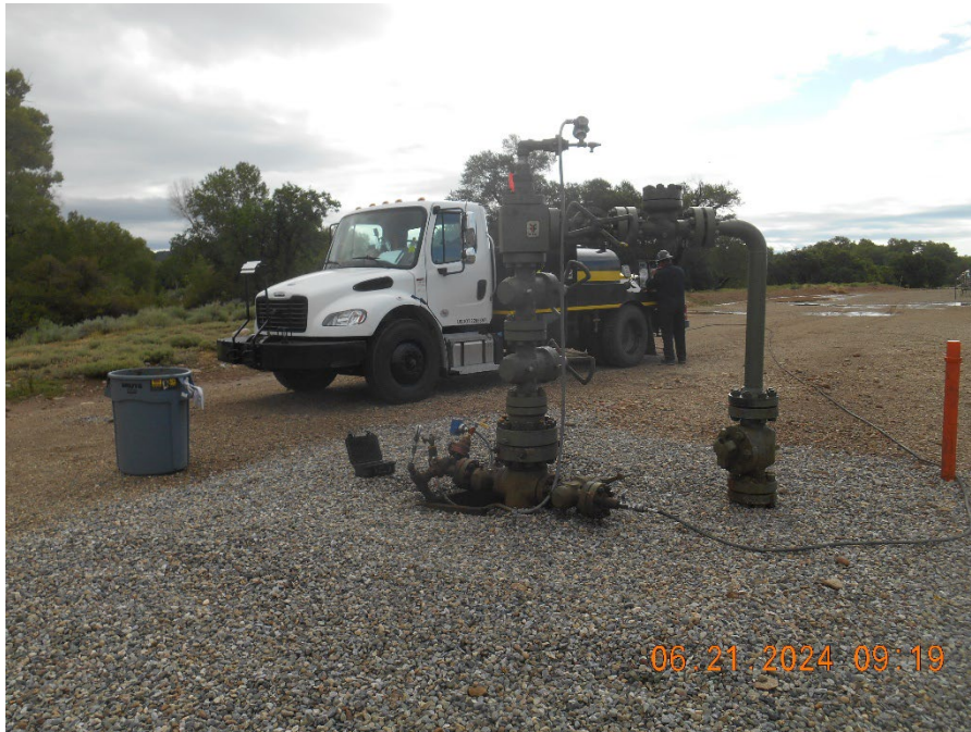
Injection wellhead during MIT
