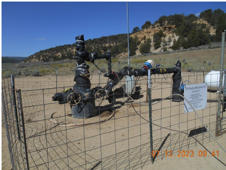
Injection wellhead during MIT
