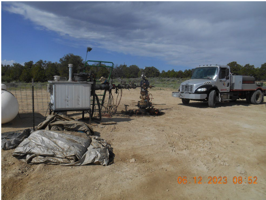
Injection wellhead during MIT
