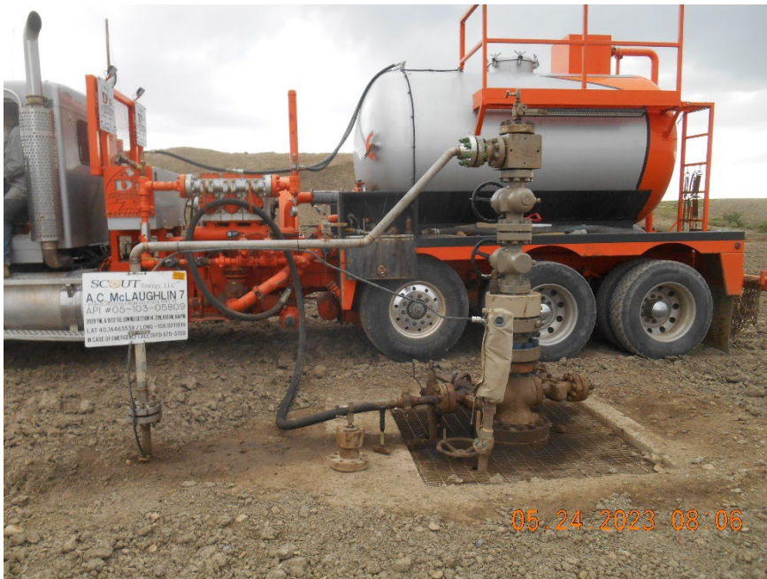
Injection wellhead during MIT
