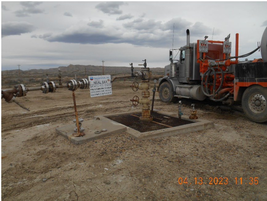
Injection wellhead during MIT
