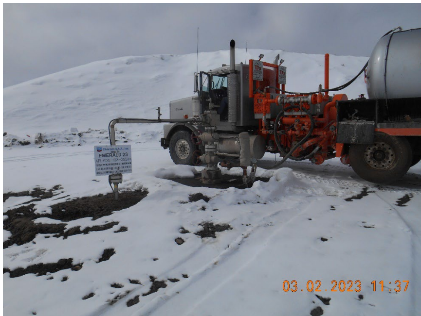
Injection wellhead during MIT
