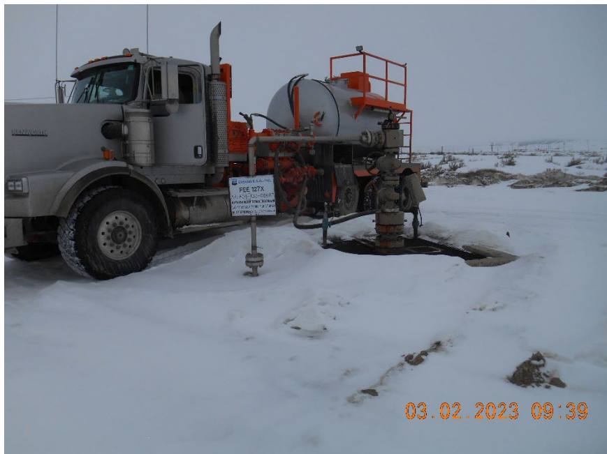
Injection wellhead during MIT
