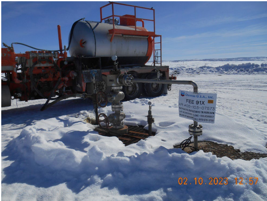
Injection wellhead during MIT
