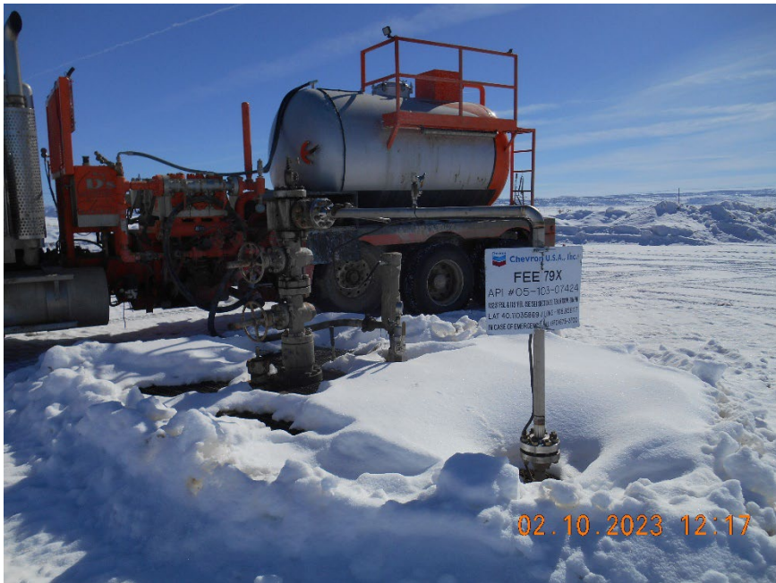
Injection wellhead during MIT
