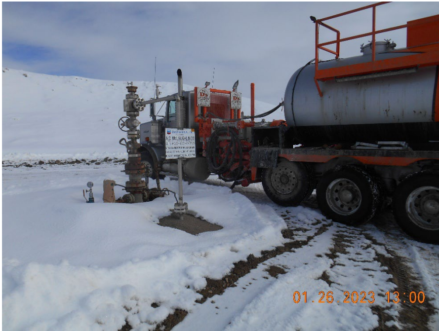
Injection wellhead during MIT
