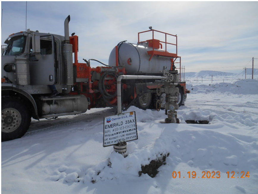
Injection wellhead during MIT
