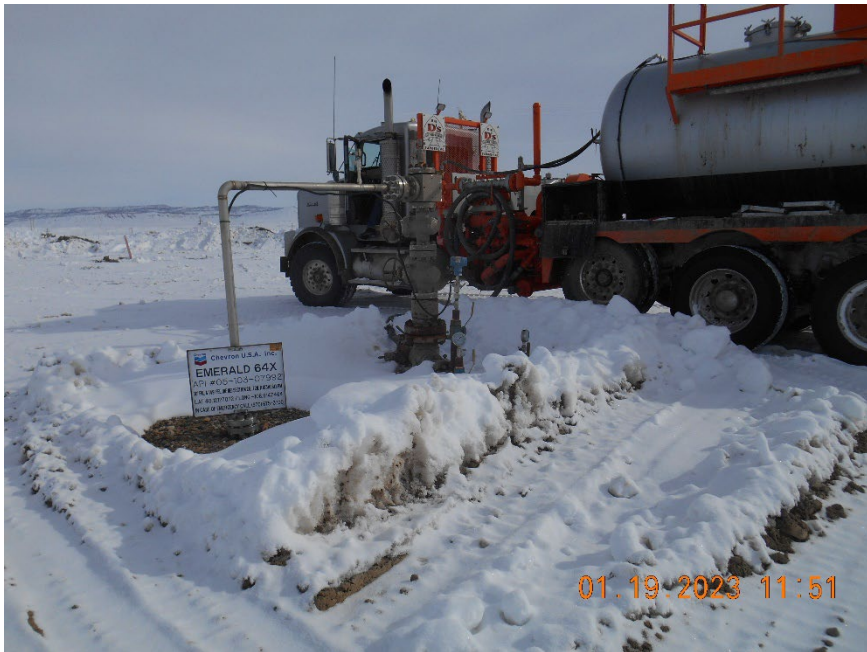
Injection wellhead during MIT
