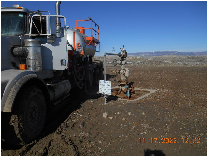
Injection wellhead during MIT
