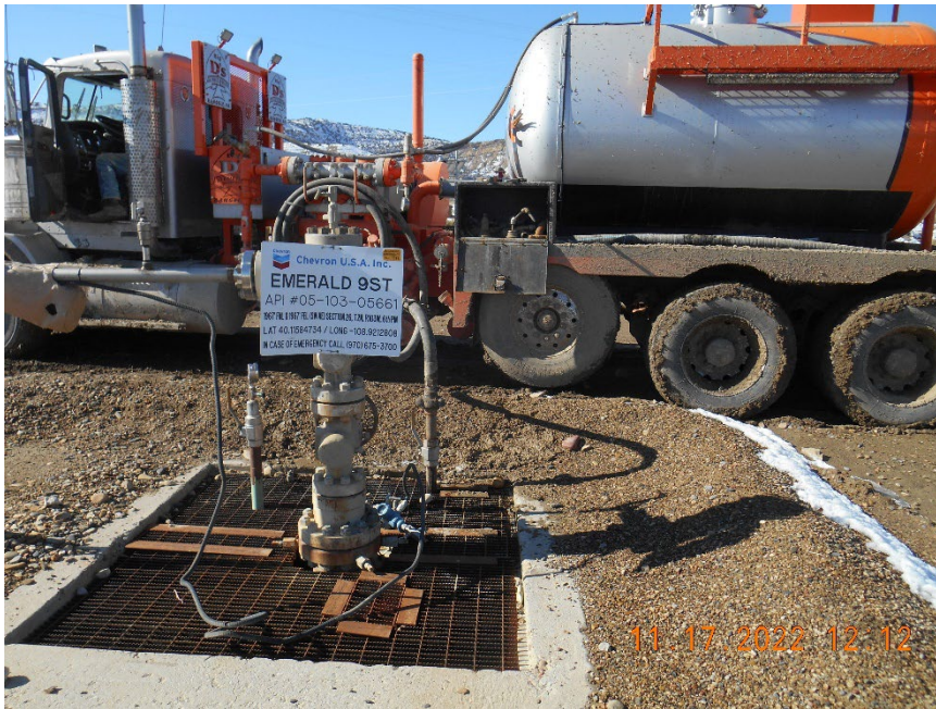
Injection wellhead during MIT
