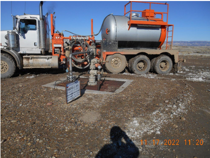
Injection wellhead during MIT
