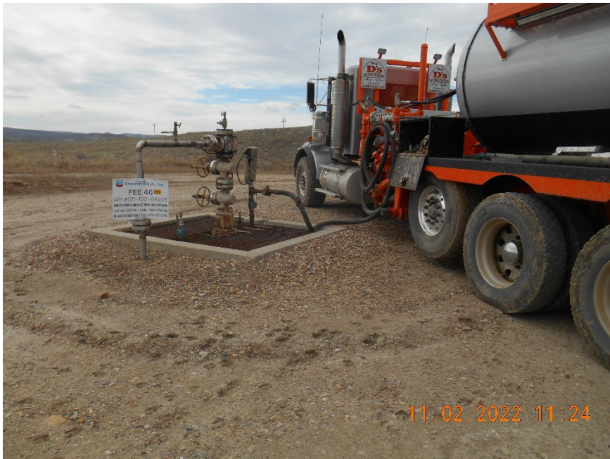
Injection wellhead during MIT
