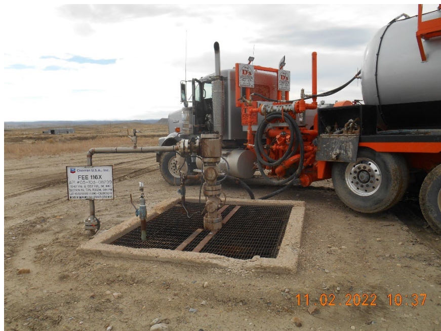
Injection wellhead during MIT
