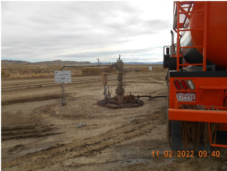
Injection wellhead during MIT
