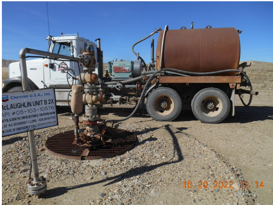
Injection wellhead during MIT
