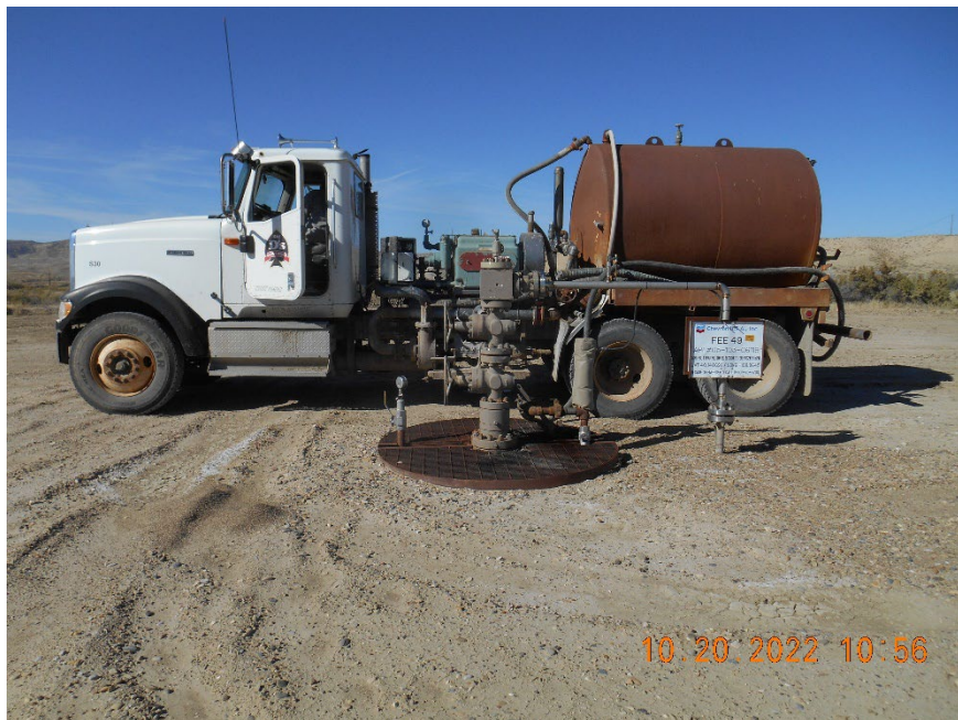
Injection wellhead during MIT
