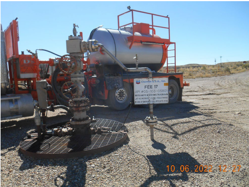
Injection wellhead during MIT
