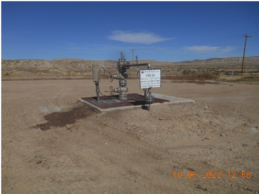
Injection wellhead during MIT
