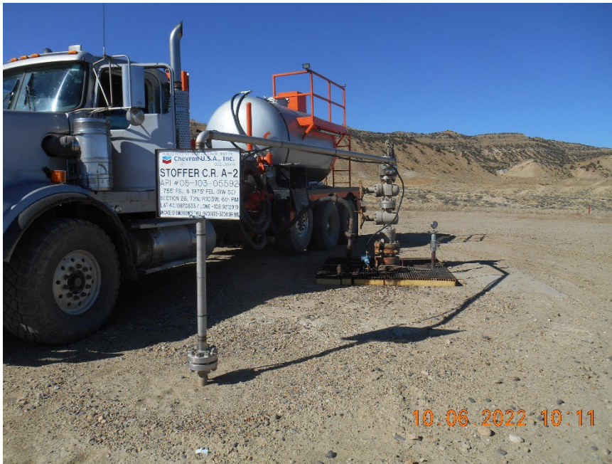
Injection wellhead during MIT
