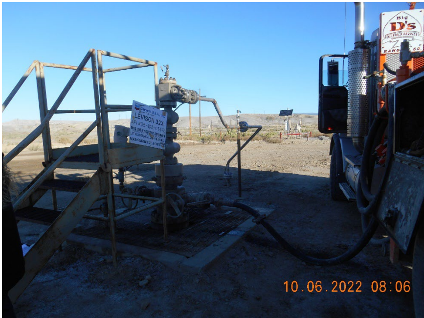
Injection wellhead during MIT
