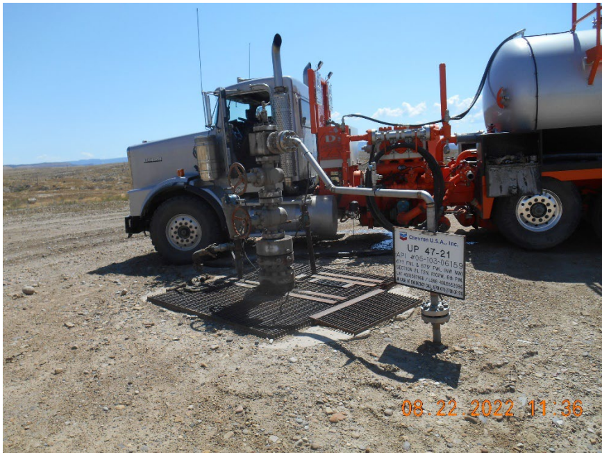
Injection wellhead during MIT
