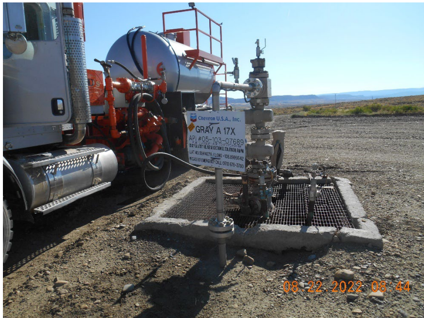
Injection wellhead during MIT
