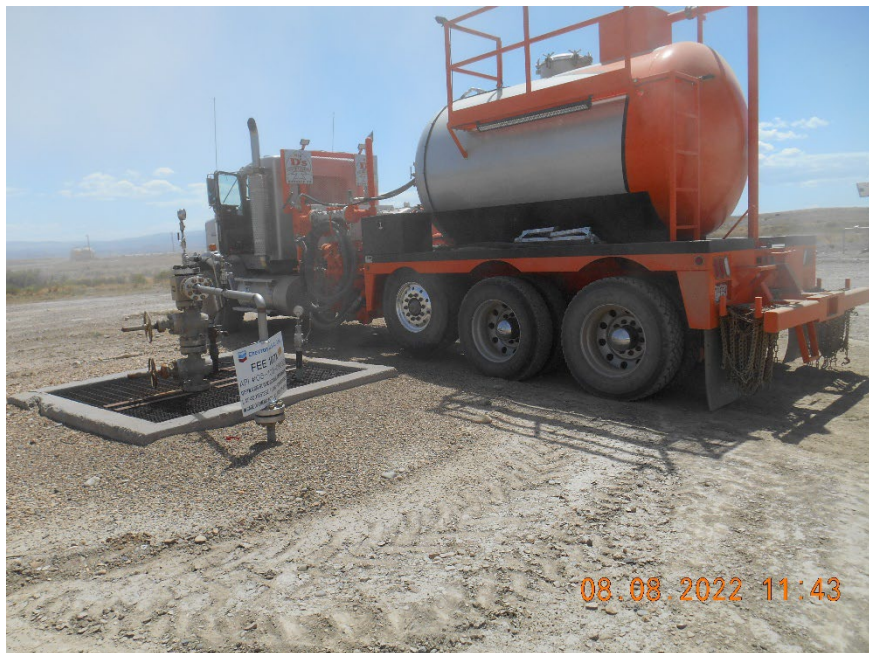
Injection wellhead during MIT
