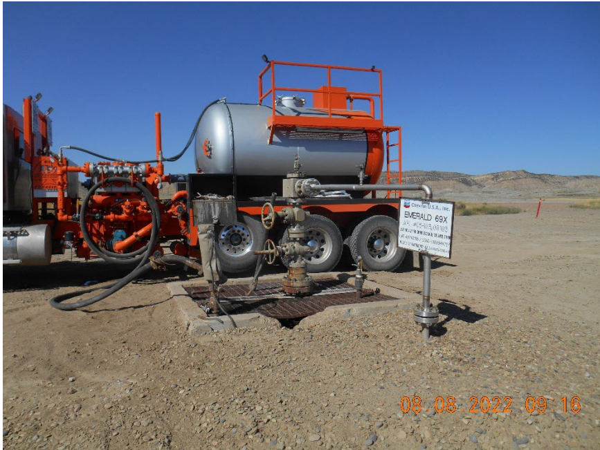
Injection wellhead during MIT
