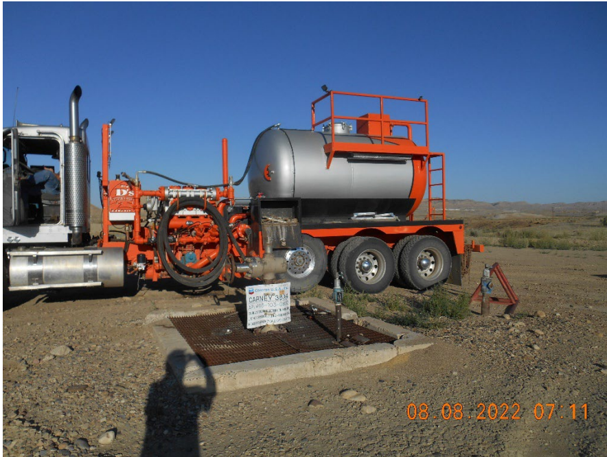
Injection wellhead during MIT
