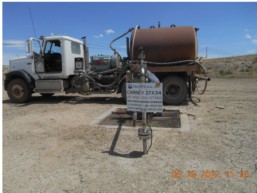
Injection wellhead during MIT
