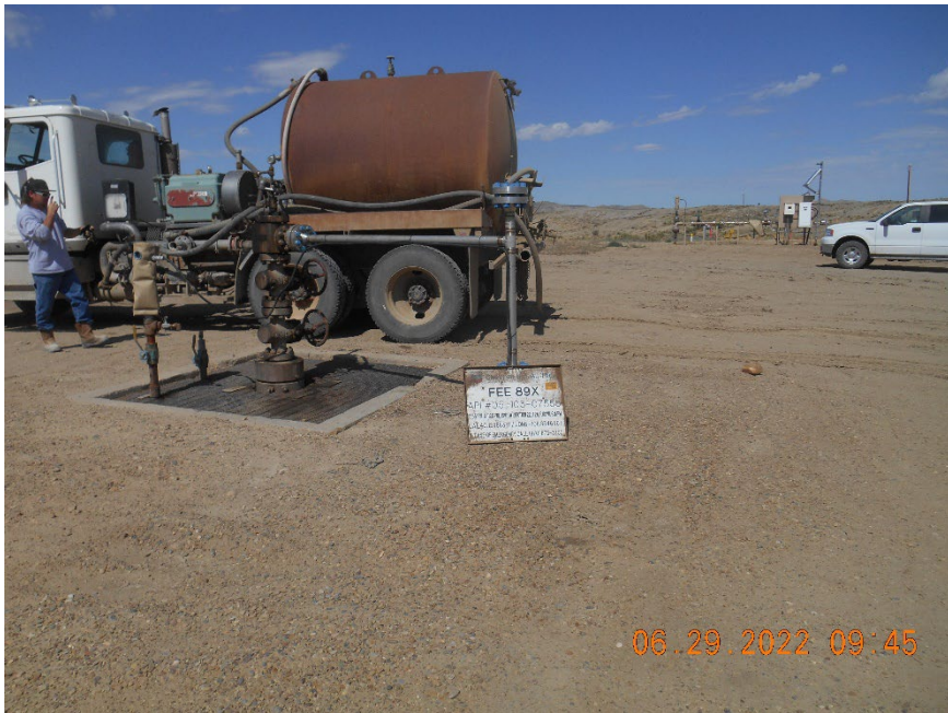
Injection wellhead during MIT
