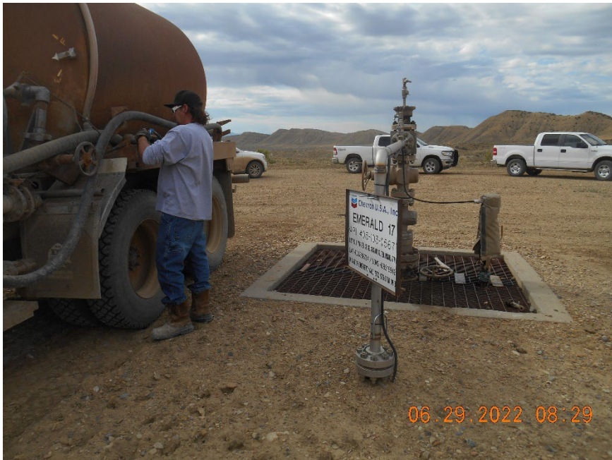
Injection wellhead during MIT
