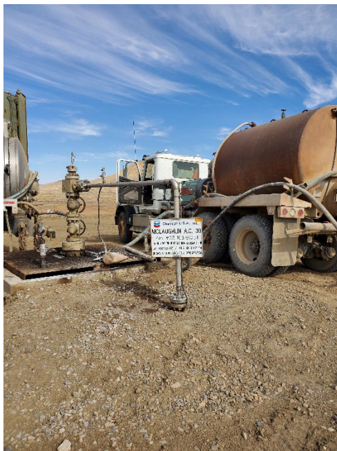
Injection wellhead during MIT
