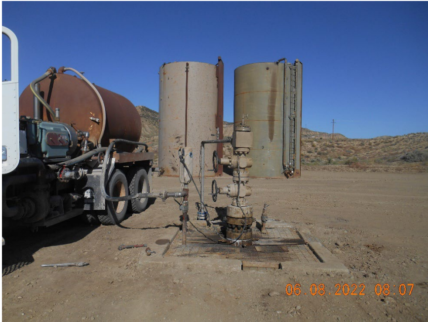
Injection wellhead during MIT
