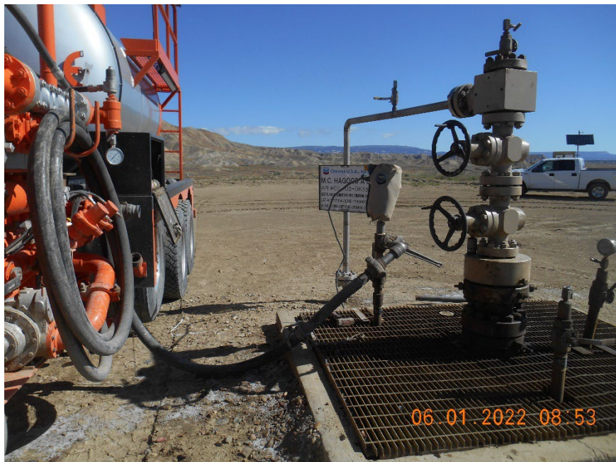
Injection wellhead during MIT
