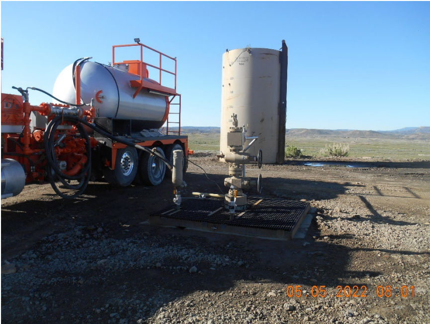
Injection wellhead during MIT
