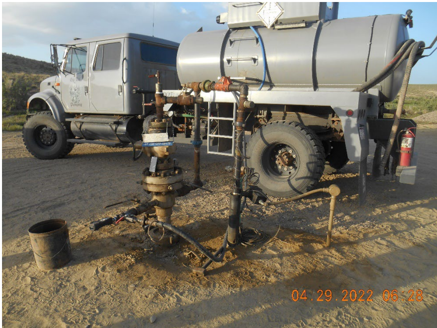
Injection wellhead during MIT
