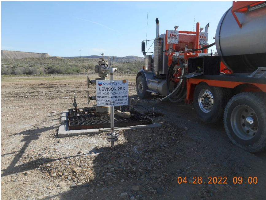
Injection wellhead during MIT
