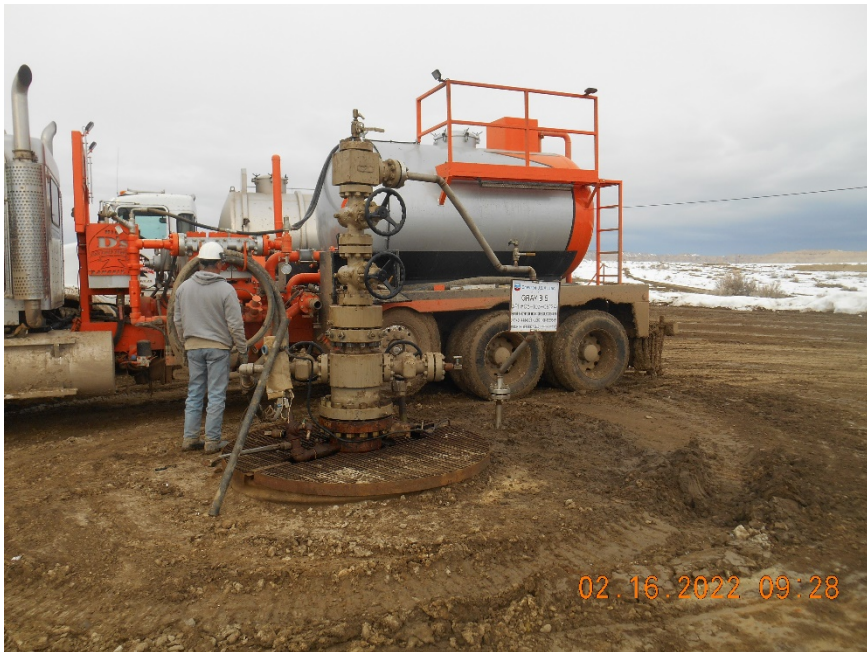
Injection wellhead during MIT
