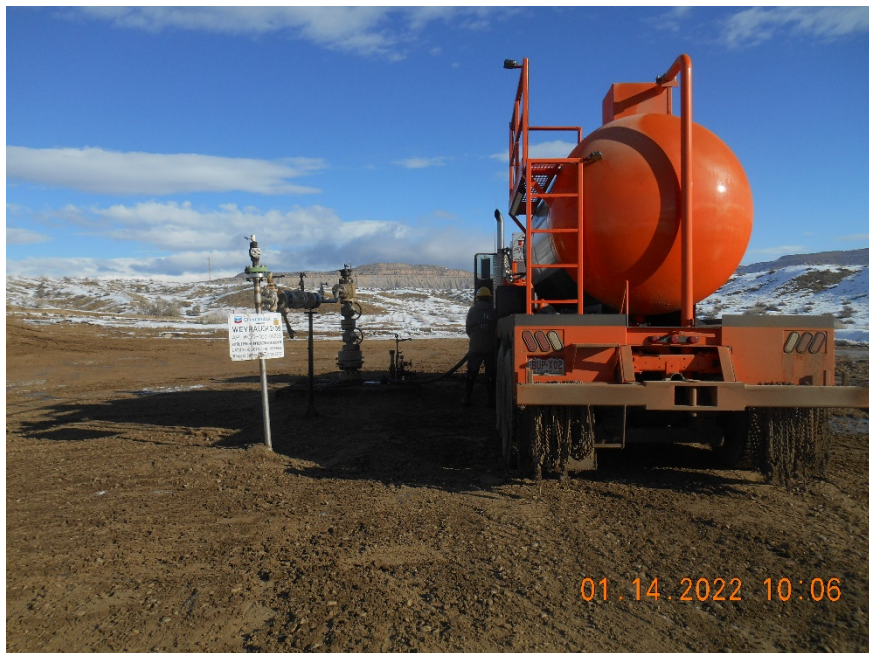
Injection wellhead during MIT
