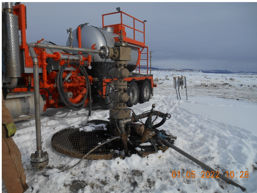
Injection wellhead during MIT
