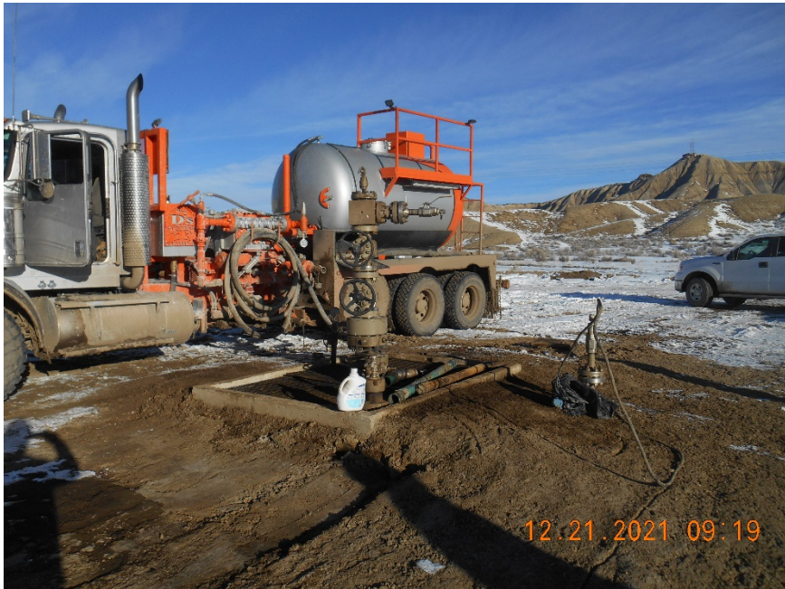
Injection wellhead during MIT
