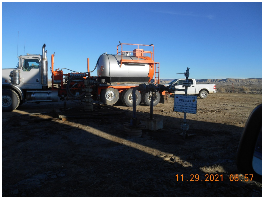
Injection wellhead during MIT
