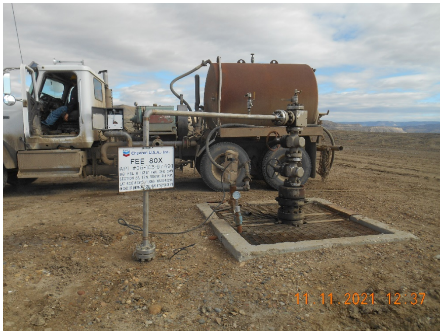
Injection wellhead during MIT
