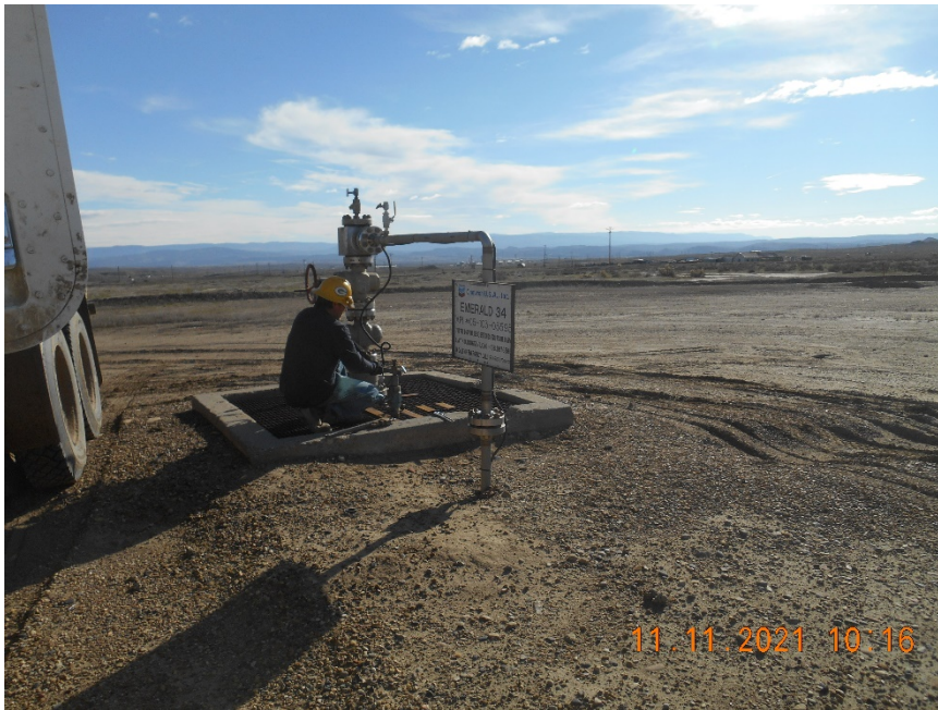
Injection wellhead during MIT
