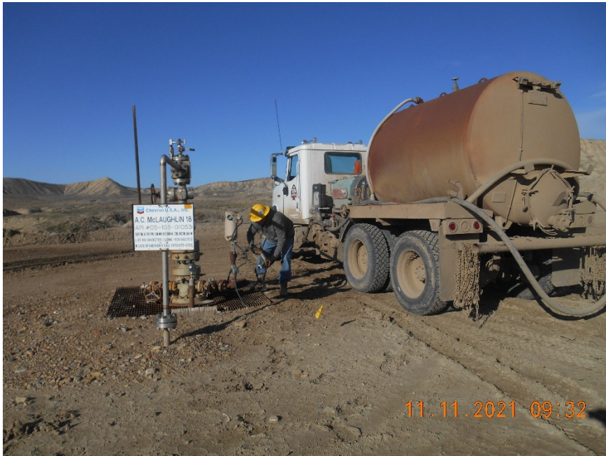
Injection wellhead during MIT
