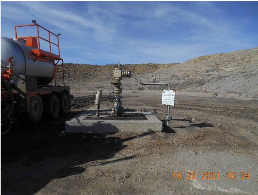
Injection wellhead during MIT
