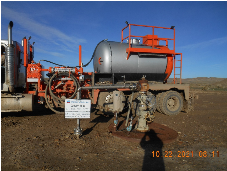
Injection wellhead during MIT
