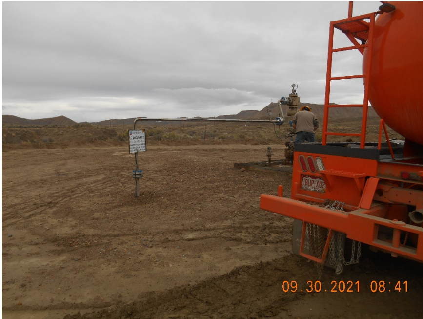
Injection wellhead during MIT
